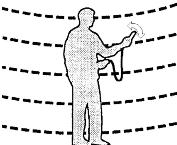
*Bild 3 Messung im magnetischen Wechselfeld, Ermitteln des Maximalwertes*
