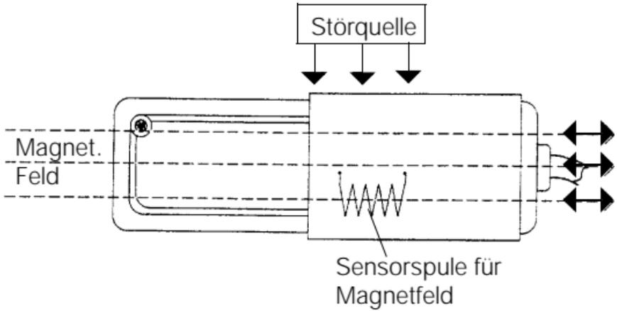
Bild 4 Lage des magnetischen Sensors im Sondengehäuse
